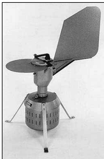
Рис. 2.1. Импорт-вольнометрическая ловушка (пылеуловитель Буркарда) (Принципы..., 1999)
